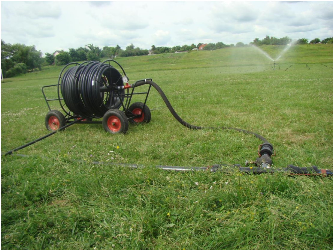
Рис. 1 б – Шланговый дождеватель
