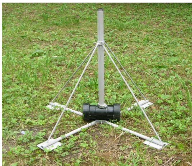
Рис. 6. Установка стояка в муфте
